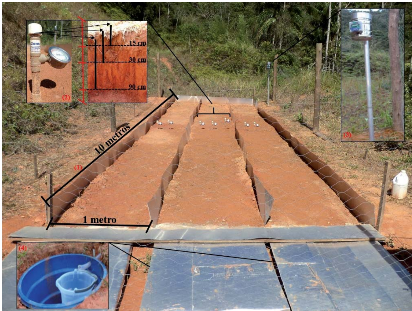
Figura 3 - Visão geral da estação experimental de erosão de solos, salientando as parcelas de erosão (1); os tensiômetros (2); o pluviógrafo (3); as caixas coletoras de sedimento (4).
